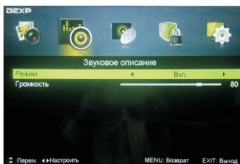
С помощью кнопок [ $\blacktriangle/\blacktriangledown$ ] выберите параметр Mode (Режим), затем выберите параметр On (Вкл.), либо OFF (Выкл.). При выборе параметра On (Вкл.), Вы можете настроить необходимый уровень звука.
