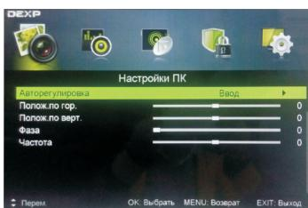
С помощью кнопок [▲/▼] выберите необходимый параметр и нажмите на кнопку ENTER, затем с помощью кнопок [▶/◀] настройте выбранный параметр. Нажмите на кнопку MENU для возврата в предыдущее меню.
