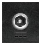
Разъем для подключения адаптера питания. К этому разъему подключается внешний адаптер питания. Используйте только штатный адаптер питания, входящий в комплект.
