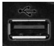
Порт универсальной последовательной шины (стандарта USB 2.0). Позволяет подключать к ноутбуку различные устройства по шине USB, обеспечивая высокую скорость передачи данных – до 480 мегабит в секунду. Этот порт соответствует стандартам Plug-and-Play для USB-устройств и совместим с предыдущим стандартом USB 1.1.
