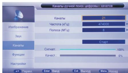
Выберите номер канала, используя кнопки ENTER или Вправо, или напрямую введите номер канала. Мощность и качество сигнала показаны в нижней части экрана. Выберите строку Start и нажмите кнопку ENTER, чтобы начать поиск канала.
