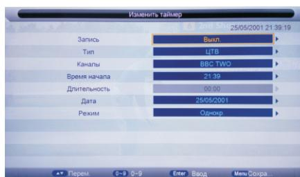
Когда придет время, установленное на таймере, система автоматически переключится на заданную программу и начнет запись (если в это время идет запись, включенная вручную, то система отключит эту запись и начнет запись, запланированную по таймеру). За 10 секунд до начала записи система выдаст соответствующее сообщение.
